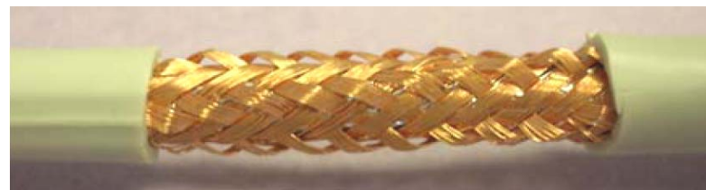
Рис 3. Видеокабель от PCT перекрученный на ~ 270°
