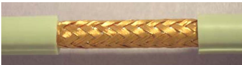
Рис 2. Видеокабель от PCT с удаленной верхней оболочкой
