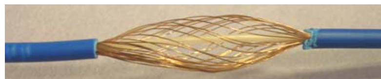
Figure 5. Видеокабель от конкурентного производителя перекрученный на ~ 270°
