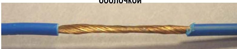
Рис 4. Видеокабель от конкурентного производителя с удаленной верхней оболочкой
