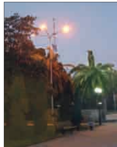
Рис. 8. Приморский парк в г. Сочи. Светильники с натриевыми лампами высокого давления на уличной опоре резко искажают цветопередачу, делают зелень пожухлой. Светильники с разрядными источниками белого света ( R_a \geq 65 ) возвращают зелени и цветочным композициям их первоначальный цвет
