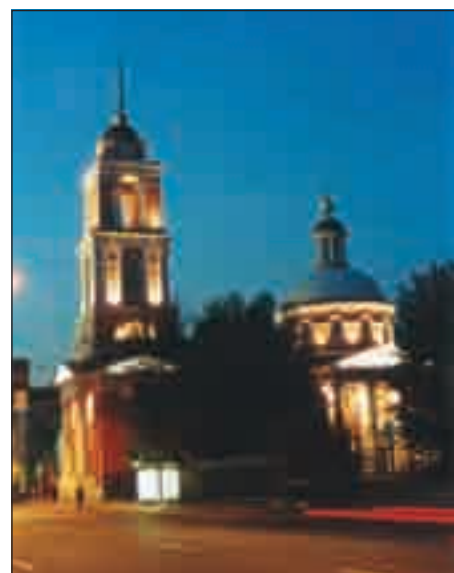
Рис. 3. Церковь Живоначальной Троицы в Вишняках на ул. Пятницкая (чрезмерное увлечение локальным приемом освещения зачастую разрушает целостность восприятия объекта)
