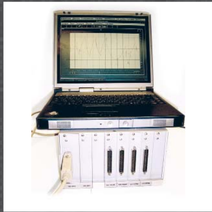
Программно-измерительный комплекс для исследования режимов работы электрооборудования в реальном времени
